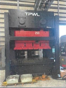
◆TPWL-250◆ 2001年製 S170mm 30-60spm 250ton DH390mm
